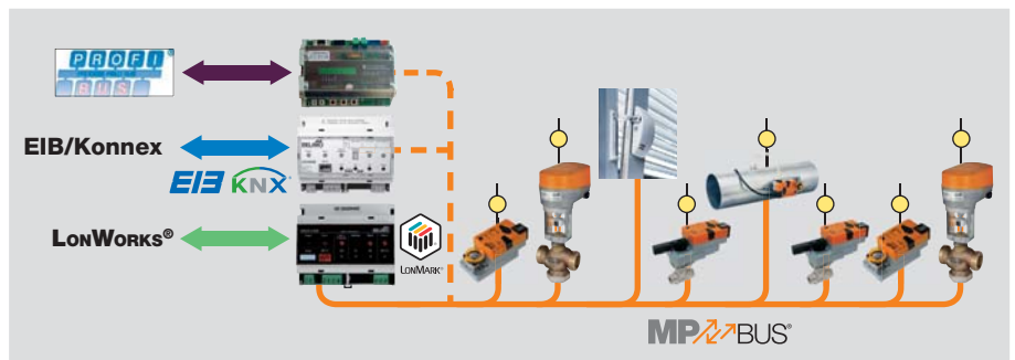
Ansatz 2: Der MP-Master ist ein MP-Gateway.
